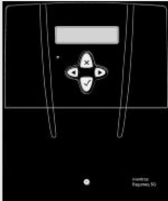
Das LC-Display ist mit einer automatischen Hintergrundbeleuchtung ausgestattet, die bei Tastendruck aktiviert wird.
